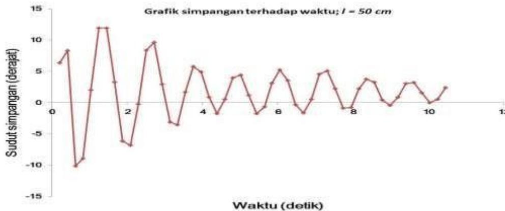
Gambar 6. Hubungan sudut simpangan dengan waktu untuk  $l = 50$  cm.
